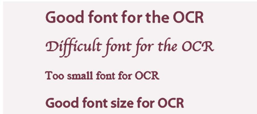
흐릿한 색상의 글자나 흐린 회색 바탕에 조금 진한 회색 글자도 쉽게 구분하는 사람과는 달리, 컴퓨터는 명확한 경계(edge)가 있어야만 글자를 구분해낸다. 이런 이유로 사진 속 옥외 간판 텍스트를 인식하는 게 책의 글씨를 인식하기보다 더 어렵다. 고품질 스캐너로 스캔한 책의 OCR 성능이 여권 이미지보다 월등히 높다. 특히 흰색 배경에 검은색 텍스트를 가장 잘 인식한다.
