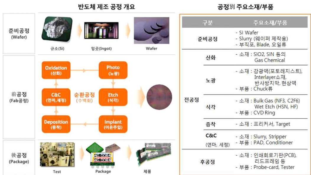
[그림4] 반도체 공정별 주요 소재 및 부품
