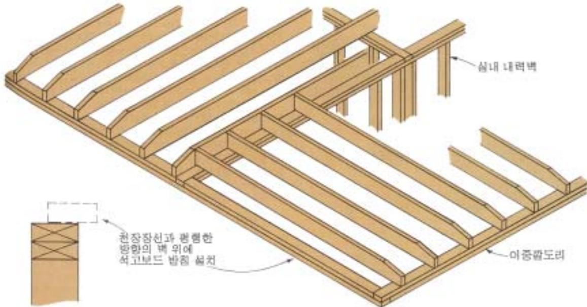
그림 88. 이중갈도리 위에 석고보드 받침의 설치.
