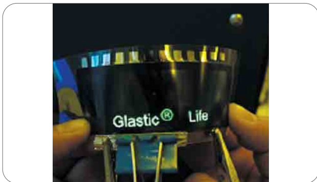
그림 1. 유연 디스플레이의 예(유리 기판상의 OLED)
