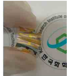
(c) 한국화학연구원에서 개발한 PES 기판을 이용한 TFT
