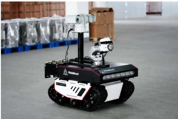
그림 32. Widemount의 지능형 소방 로봇
