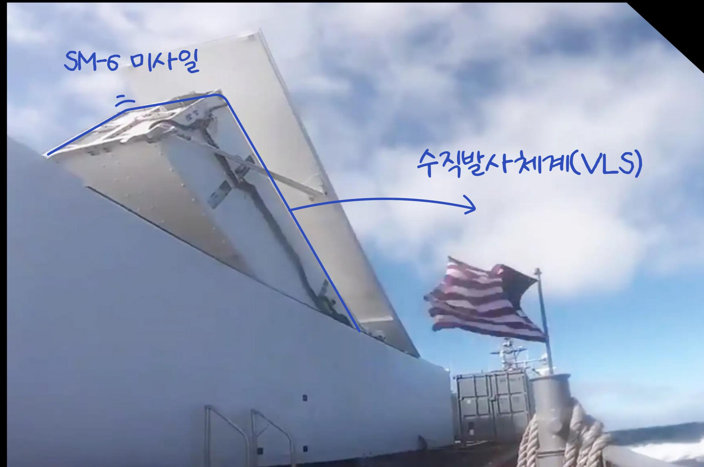
해당 영상은 미 해군의 대형무인수상함(LUSV, Large Unmanned Surface Vehicle)인 'RANGER'에서 레이시온의 스탠다드 미사일 SM-6를 발사하는 실사격 시험을 공개한 것이다. 표준 선적 컨테이너와 비슷한 크기의 흰색 상자 속에는 Mk.41로 보이는 4셀 모듈이 실려 있다. Mk.41은 SM-6 미사일을 발사할 수 있는 미 해군 함정의 표준 수직발사체계(VLS, Vertical Launching System)다. 상업용 보급선이 사실상 이지스 구축함 수준의 무장을 탑재하는 셈이다. 애초에 이 보급선은 군용으로 설계된 함정이 아니다. 일반 상업용 배로 절반 정도 건조된 와중에 미 해군이 구입했다. 다수의 상선에 컨테이너 박스로 위장해 적에게 발사 원점을 들키지 않으려는 의도가 있음은 분명해 보인다. 고정된 활주로와 육상 발사 위치와 관계없이, 바다에서 예측 불가능한 기동 모바일 자산을 보유한다는 것은 전술적으로 매우 유리한 고지를 점령한다.
