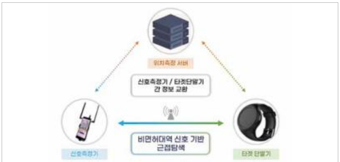
<그림 1> 비면허대역 신호기반 정밀 위치측정 기술의 구성도
