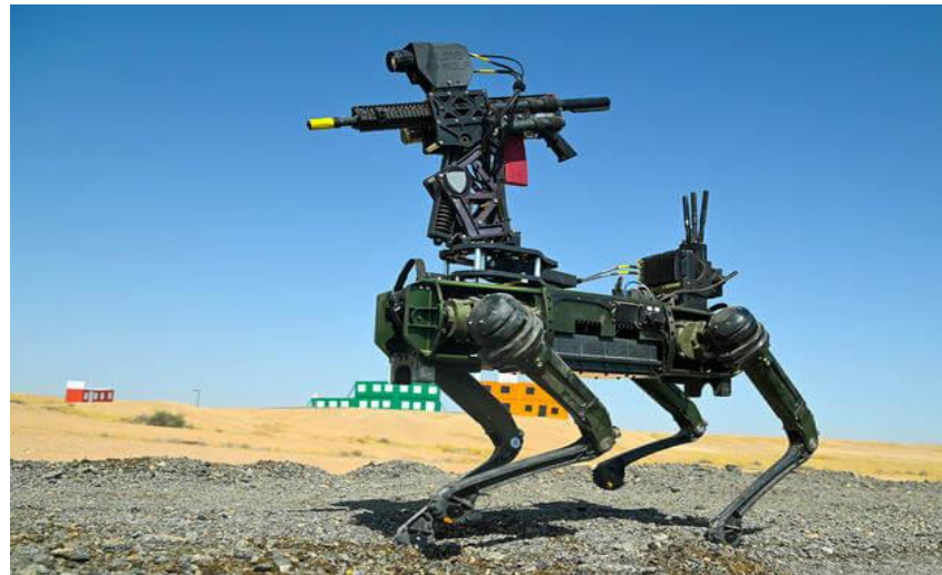
<그림> 무기 탑재 테스트 중인 Ghost Robotics의 Vision 60
