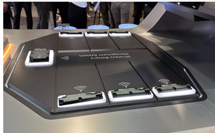
<그림> Wireless Battery Management System - EV 배터리 모니터링 및 관리
