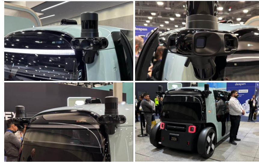
<그림> Roof의 모서리에 Sensor fusion 모듈을 장착한 Zoox
