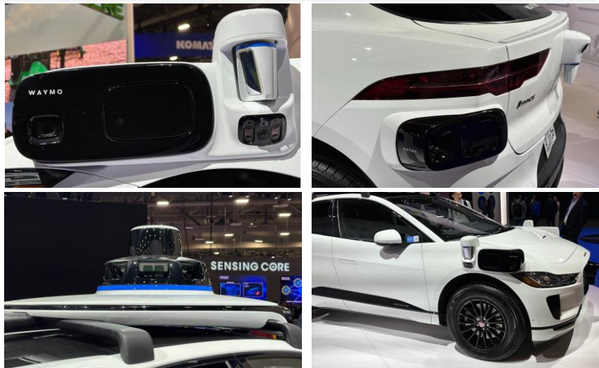
<그림> 카메라, 레이더, 라이다의 퓨전으로 강력한 Redundancy 추구하는 Waymo
