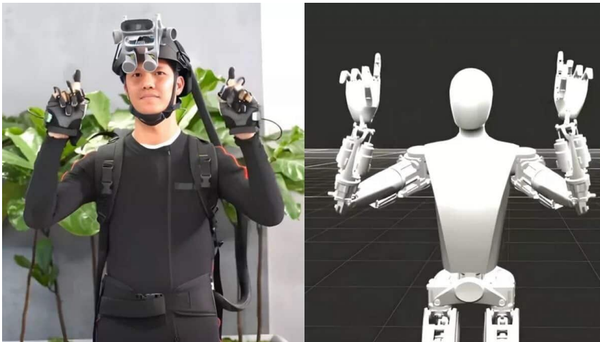
<그림> Teleoperation 방식으로 수집하고 있는 Optimus의 Real Data
