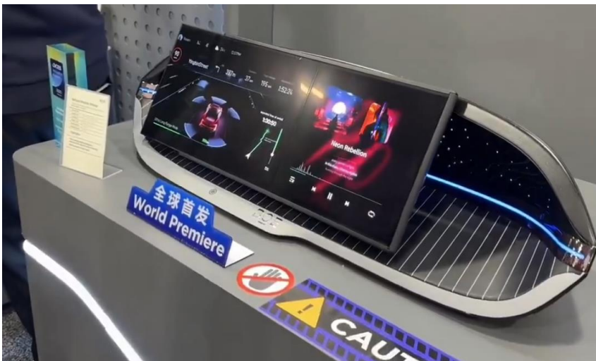
<그림> BOE의 스플라이스 슬라이딩 디스플레이 (f-OLED 이용)
