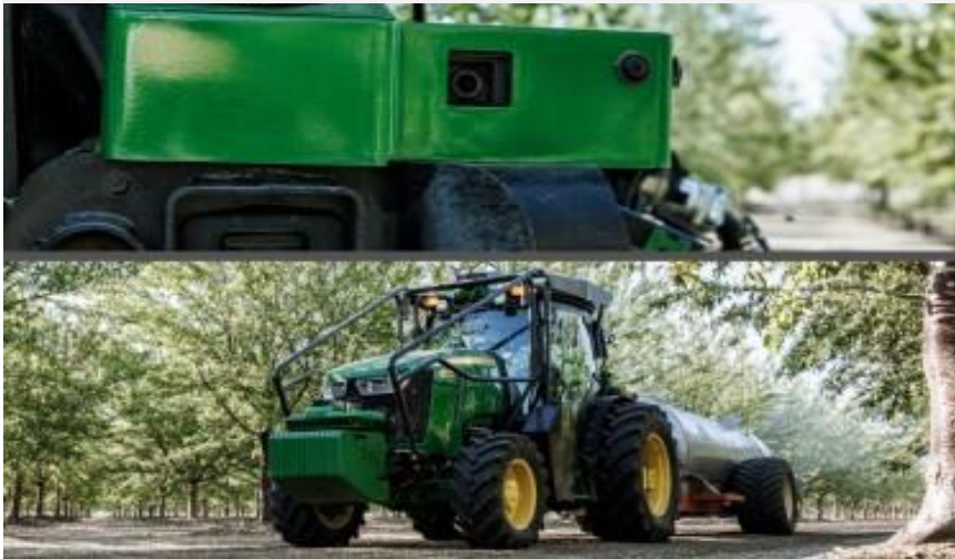
<그림> 과수원용 차세대 인식 키트는 기존 키트보다 카메라 어레이가 적지만 통합 LiDAR 센서를 추가, 나무 캐노피와 3D 이미지를 실시간으로 촬영 가능
