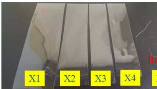
그림 14. 연신온도와 연신 비 변화에 따른 연신 된 필름 (R6)
