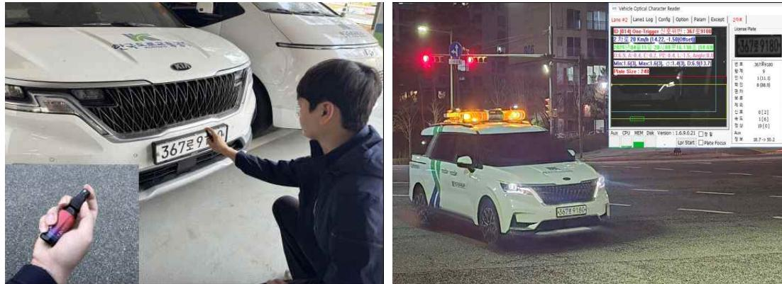
한국도로교통공단과 경찰청은 무인교통단속장비를 대상으로 '자동차번호판 가림용 스프레이'의 인식성능 방해 여부 확인을 위한 테스트를 진행했다. (좌)자동차번호판에 스프레이 사용 후 (우)야간 테스트 인식결과 <시진제공-한국도로교통공단>
