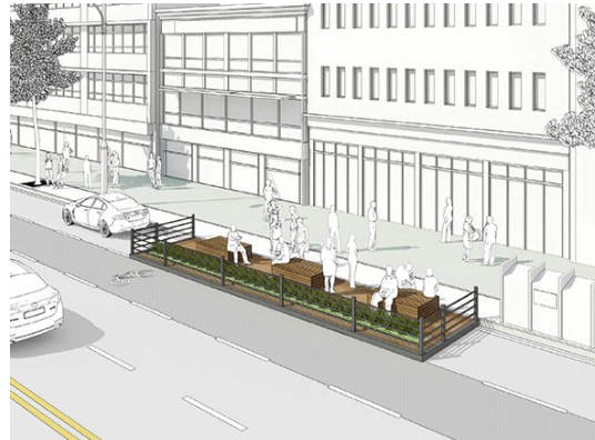
〈그림 6-5〉 도로변 미니공원(파클렛, parklet) 설치 예시
