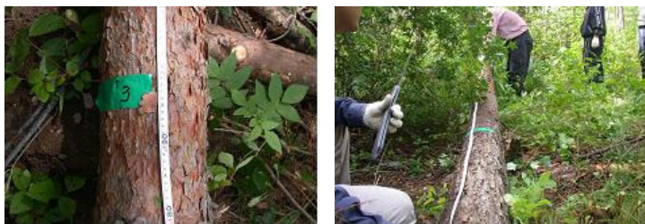
〈그림 2〉 재적 및 간중량 환산용 원판 채취 부위 표시
