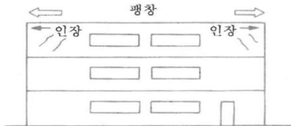
그림 2.4 외부온도 응력에 의한 균열
