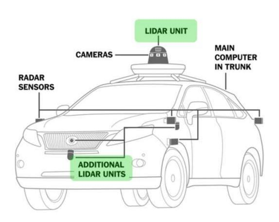
참고로 LIDAR (Light Imaging Detection and Ranging)는 표면 위의 물체와 그 크기 및 정확한 배치까지 감지하는 기술입니다. LIDAR와 RADAR의 가장 큰 다른 점은 이들의 작동원리는 거의 다르지 않지만, 물체를 감지하는데 각각 다른 시그널을 사용한다는 것입니다. RADAR에서 전파로 주변을 스캔하는데 비해 LIDAR에서는 레이저 광펄스를 사용합니다.
