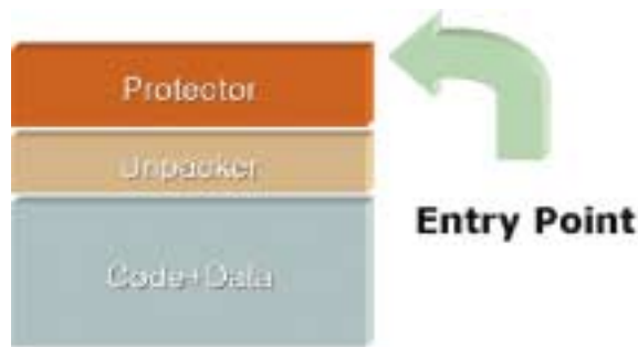
[그림 38] 실행압축과 파일보호를 했을 때 파일 구조
