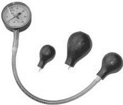
**Abb. 3.4** Vigorimeter mit auswechselbaren Gummiballons
