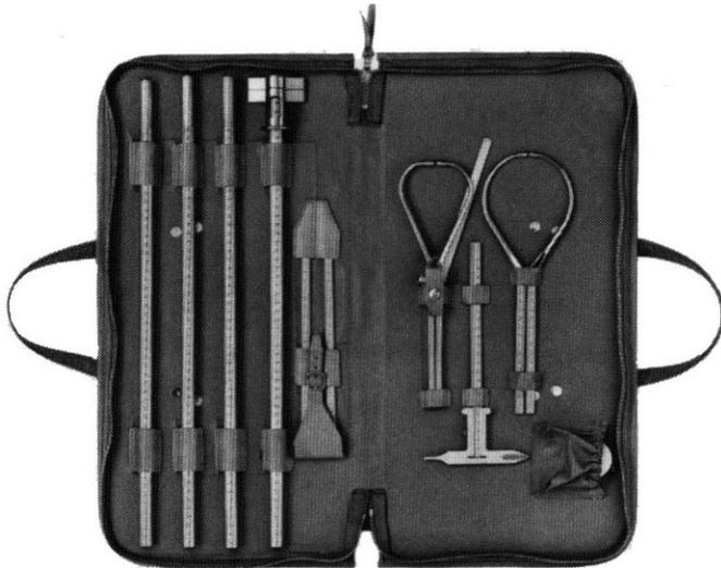
**Abb. 3.1** Instrumententasche mit Anthropometer, Stangenzirkel, Kleinem Tasterzirkel und Gleitzirkel
