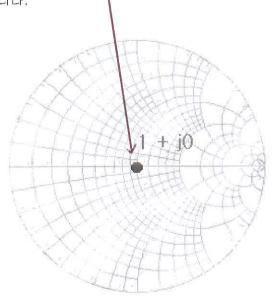
스미스차트 좌표는 어떤 특성임피던스에서도 동일하게 적용할 수 있으려면, 중심점이 50, 66, 75와 같은 어떤 특정한 하나의 임피던스좌표를 지칭해서는 안되겠죠. 그래서 스미스차트는 1이라는 임피던스 점을 기준으로 만들어놓고, 해당 임피던스점들을 각각의 회로와 시스템 특성에 맞는 임피던스로 나누어 쓰게 하는 것입니다. 결국 이것도 편하자고 이러는 것입니다.
