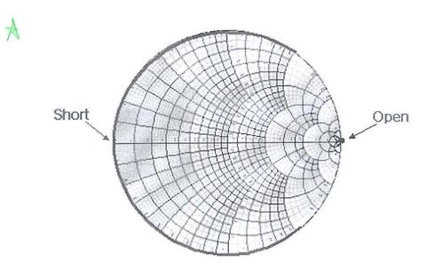
그래서 임피던스 점이 왼쪽에 있으면 낮은 임피던스, 오른쪽으로 가면 높은 임피던스점을 의미하게 됩니다. 이러한 점들은 좌표만 읽을 줄 알아도 바로 알 수 있는 것이므로 외우지 말고 이해하도록 하세요. 처음에 배울 때는 뭐가 뭔지 몰라서 마냥 외우기만하는 경우가 많은데, 임피던스가 0 인 원은 short가 되고, ∞ 인 원은 open이 된다는 것을 잘 음미해보시기 바랍니다.
