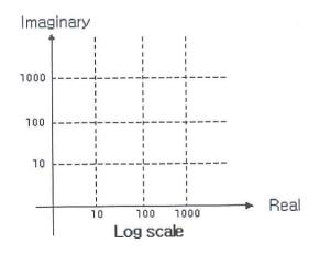
이렇게 log 스케일로 나타내면, 낮은 임피던스는 자세하게, 높은 임피던스는 듬성듬성 표현이 가능하여 여러모로 사용하기가 더 편리할 것입니다. 하지만 임피던스가 아주 높아진다면 좌표계가 계속 더확장되어야 할 것입니다. 그렇다면 왠지 조금은 불편한 감이 있습니다. 이걸 무한 대점까지 한큐에다 표현되도록 할 수 없을까요?
