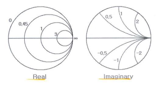
흠~ 뭐 좌표계가 좀 야리꾸리하게 생기긴 했지만 한두 번 점찍어보면 별거 아닙니다. 실수부는 수평선을 따라 오른쪽 끝이 무한 대의 중심점이 되고, 왼쪽으로 중심이 이동할수록 점점 값이 작아집니다. 즉 임피던스 점이 위치하는 곳을 지나는 원의 좌표값이 실수부 좌표가 되지요. 허수부의 경우는 오른쪽 끝을 기준으로 점점 퍼져나가는 포물선 형상이며, 위쪽은 + 부호로, 아래쪽은 - 부호의 좌표로 정의됩니다.
