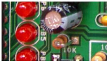
[그림9-1 10uF 전해콘덴서 납땜 후 모습]
