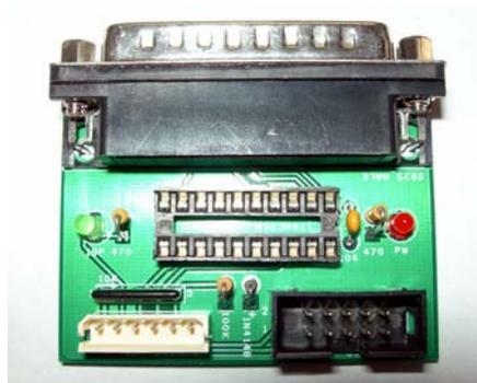
[그림9 25핀 DSUB 납땜 후 모습]
