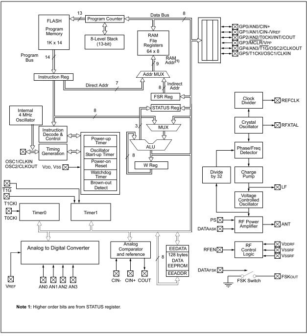
FIGURE 1-1: rfPIC12F675 BLOCK DIAGRAM
