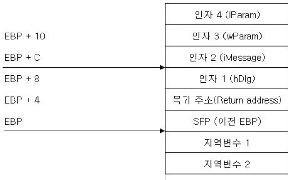
[그림 2-3] 메시지 처리함수의 스택 구조 (함수 전처리 과정 직후)
