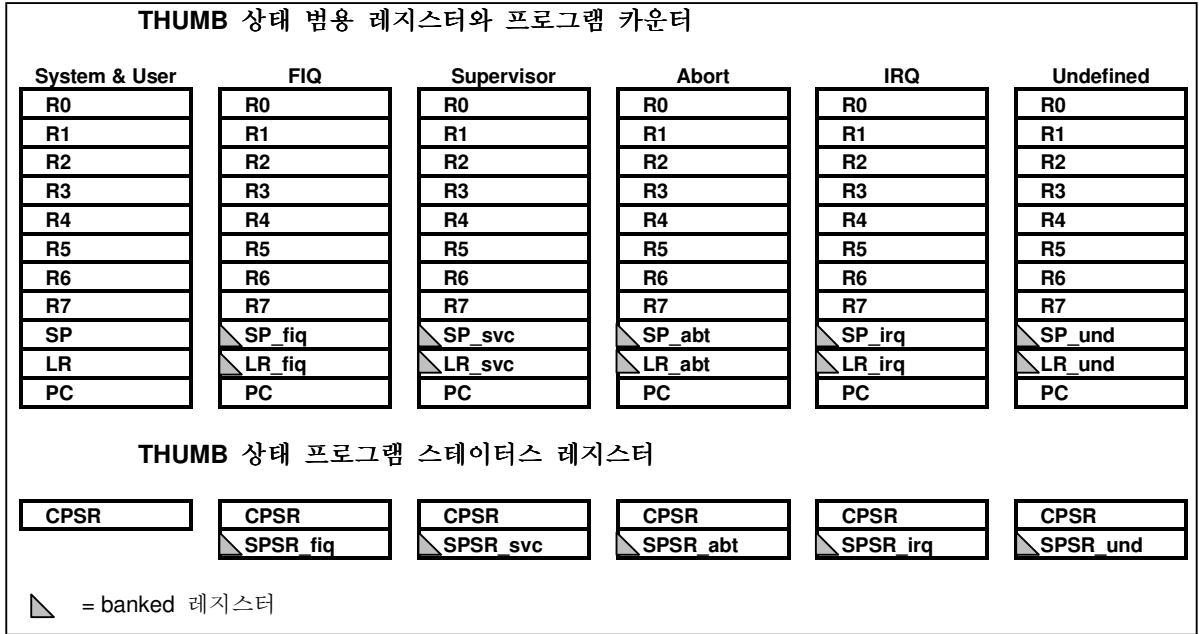
그림 2.5 THUMB 상태에서의 레지스터 구성
