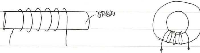
$$L = \frac{\Phi}{I} = \frac{\text{전류에 의한 자속과 Coil의 쇄도자속}}{\text{Coil에 의한 자속.}}$$
