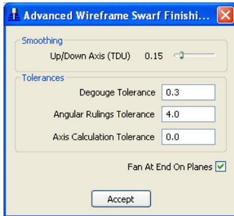
Wireframe swarf (고급 와이어프레임 스왑 가공)은 복잡한 형상의 가공에도 좋은 품질의 면을 생성할 수 있도록 자동으로 툴 패스를 생성하지만 공차문제나 선택한 커브 또는 서피스 사이의 거리가 적당하지 않은 관계로 만족할 만한 결과를 얻지 못 할 수도 있다. 위의 창을 이용하여 이런 문제를 해결 할 수 있다.
