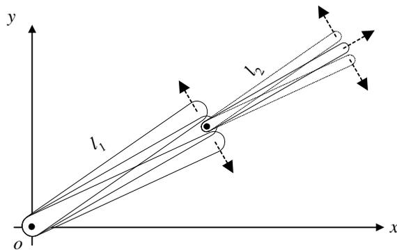
그림 3.4 로봇의 특별한 상태에서 미소한 움직임
