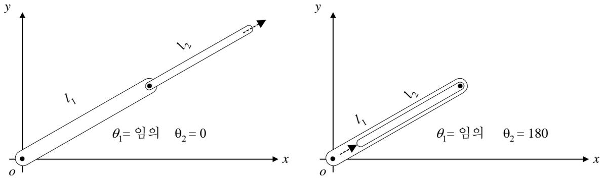
그림 3.3 로봇의 특별한 상태
