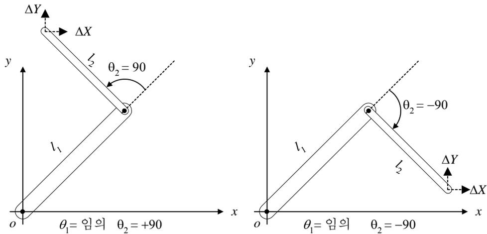
그림 3.5 로봇의 특별한 상태2
