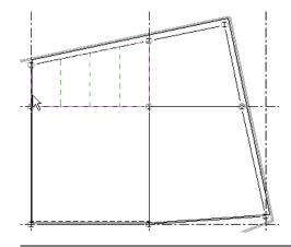
주 점선은 보 시스템 방향을 나타냅니다. 보 시스템 부재의 세로 축은 이러한 선에 평행하게 배치됩니다.
