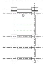
주 점선은 보 시스템 방향을 나타냅니다. 보 시스템 부재의 세로 축은 이러한 선에 평행하게 배치됩니다.
